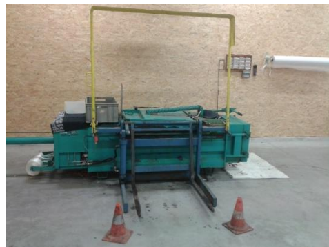
Εικόνα 16: Χώρος αποθήκευσης – συμπίεσης μικρών ανακυκλώσιμων αποβλήτων
